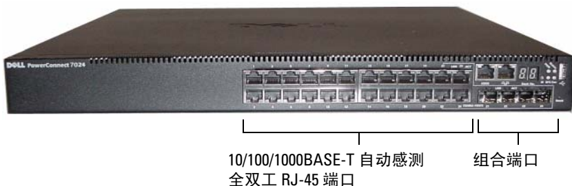
图 1-1. PowerConnect 7024, 具有 24 个 10/100/1000BASE-T 端口
