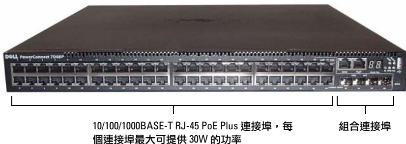
圖 1-5. PowerConnect 7048P，具有 48 個 10/100/1000BASE-T PoE Plus 連接埠
