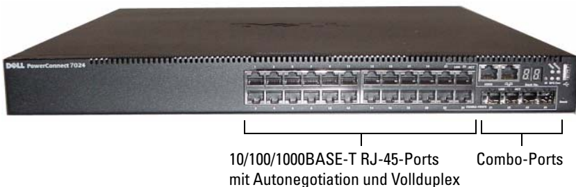
Abbildung 1-2. PowerConnect 7024P mit 24 10/100/1000BASE-T PoE Plus-Ports
